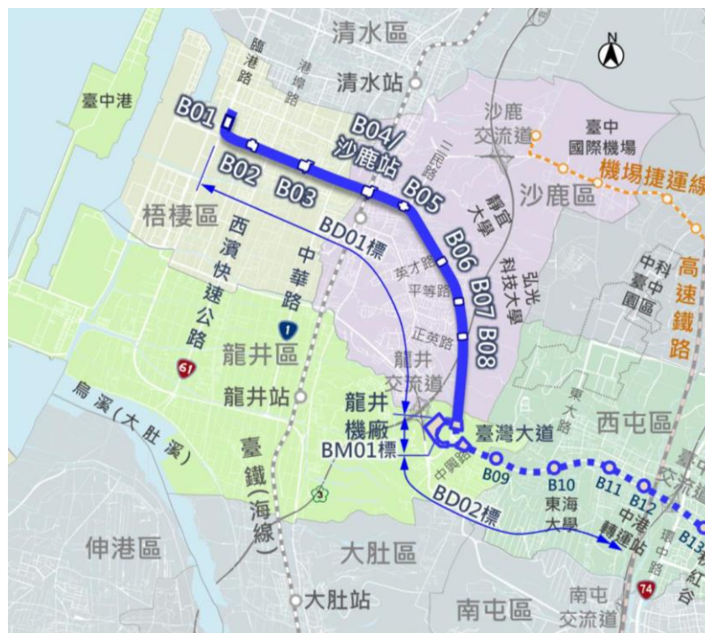
圖 2 捷運藍線(BD01 工程)高架穿越工程範圍示意圖
